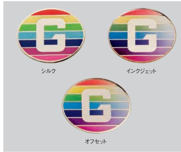
オフセットプリントは色分解(写真製版)をした版を使用することにより、グラデーションの描写ができます。また、CMYKの4色分解をすることにより、自由な色表現ができます。
