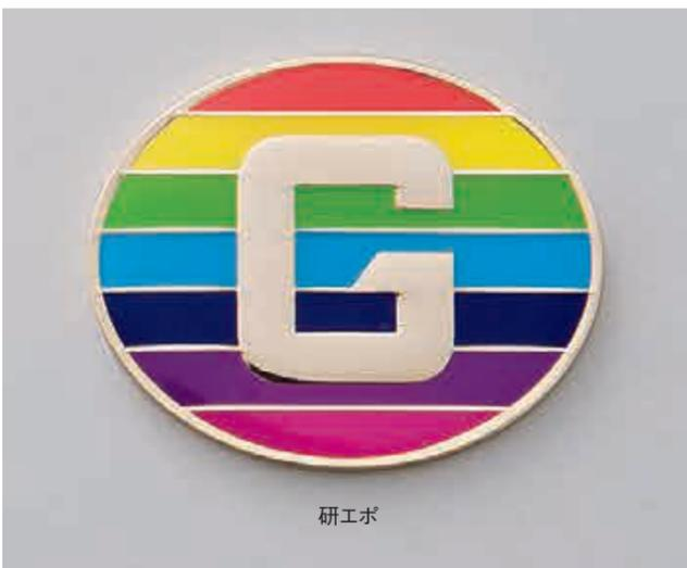
研ぎエポとは、プレス加工して硬質の塗料で埋めた後、200～300℃で焼き付けた後表面を研磨します。表面を研磨するため、高級感が出ます。七宝と違いDIC・Pantoneでの色指示が可能です。また、研ぎエポ加工は印刷と併用することができるのも大きな特徴です。※オフセットは不可
