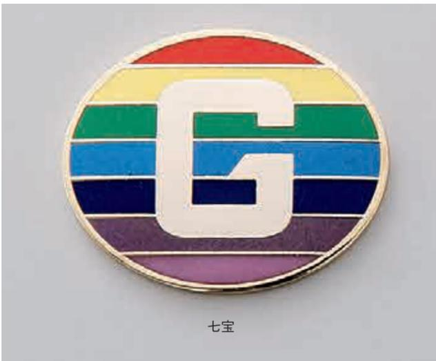
七宝とは、ガラス繊維が入っているインクを使用し、800℃くらいの高温で焼き付けます。焼き付けることにより、ガラス粉末が凝固して、ガラスがそのままバッジに閉じ込められたような仕上がりになります。七宝の色は決められた色しか使用することができないので、指定色に近い色での製作になります。また、高温で焼き付けるため、金属板が若干反ることもあります。
